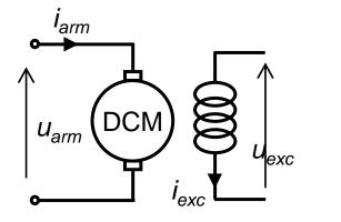
$\begin{cases} T_{dcm} = k \ i_{exc} \ i_{arm} \\ e_{arm} = k \ i_{exc} \ \Omega \end{cases}$
